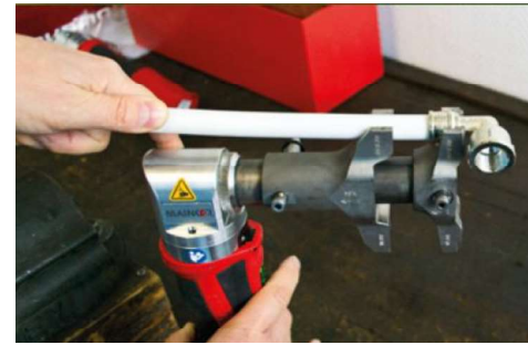
5. Terminado del Montaje con el conector del tubo compresionado
